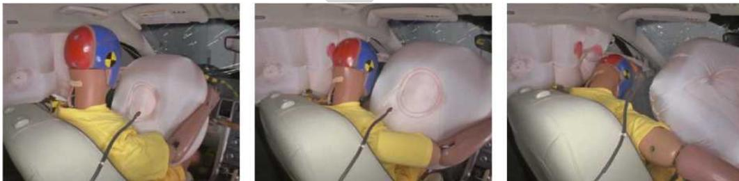
注：碰撞过程中，假人头部完全没有接触正面安全气囊，且没有其它措施防止头部与安全气囊前方的硬体结构接触。
