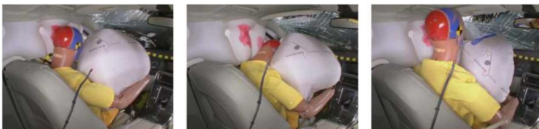
注：碰撞过程中，假人头部滑入正面安全气囊和侧面头部保护安全气囊之间的间隙之前短暂地受到了正面安全气囊的作用力（正面安全气囊较窄，且没有其它措施防止头部与安全气囊前方的硬体结构接触）。
