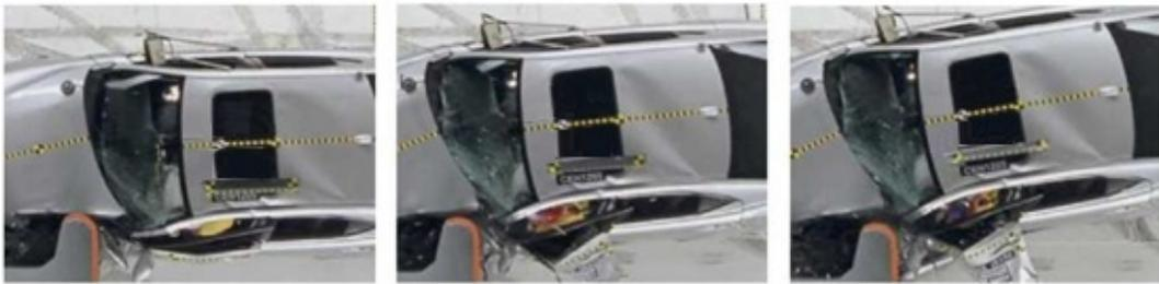
注：假人向外运动时，由于车辆内部结构以及缺乏侧面头部保护安全气囊等原因，假人头部移动到了驾驶员侧窗未变形前的轮廓外侧。
