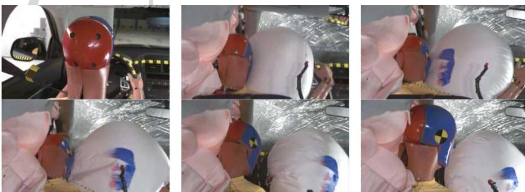
注：碰撞过程中，假人头部受到了正面安全气囊的作用力，随后直接滑到左侧，而且没有其它措施防止头部与安全气囊前方的硬体结构接触。
