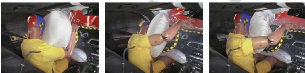
注：碰撞过程中，假人头部受到了安全气囊的作用力，但随后绕气囊旋转滑到了左侧，而且没有其它措施防止头部与安全气囊前方的硬体结构接触。
