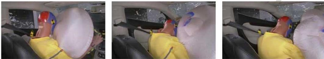
注：碰撞过程中，假人头部在滑动到左侧之前几乎没有接触到正面安全气囊，且没有其它措施防止头部与安全气囊前方的硬体结构接触。
