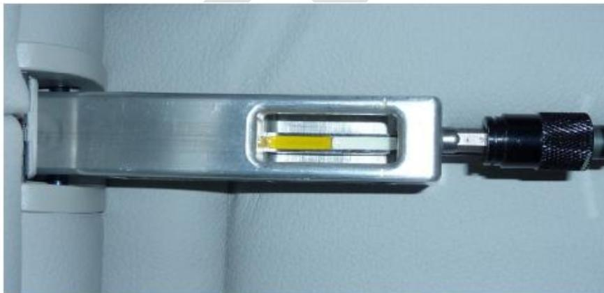
图 7 连接力测量
