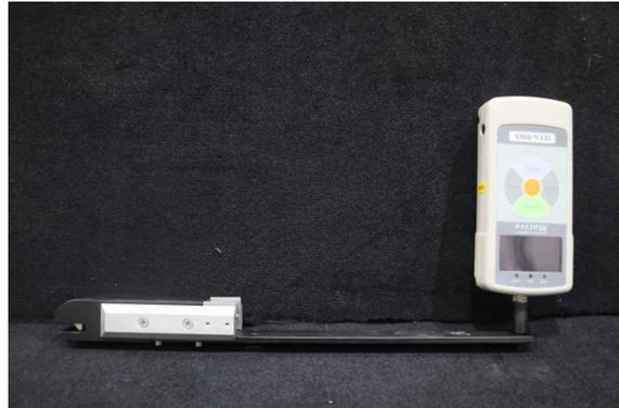
图 2 间隙角度测量工具
