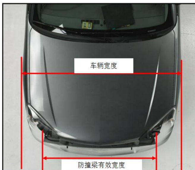
图 4.8 防撞横梁有效宽度和车辆宽度测量
