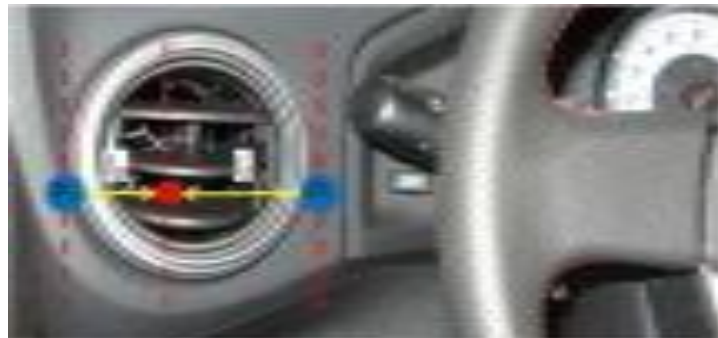
图 9 用于测量软性部件上测量点的图示
