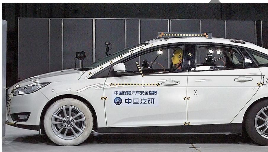
图 B. 1 后车门锁扣标识到方向盘中心标识之间距离的测量
