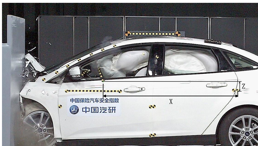
图 B.3 标记车门上的方向盘中心（碰撞中）
