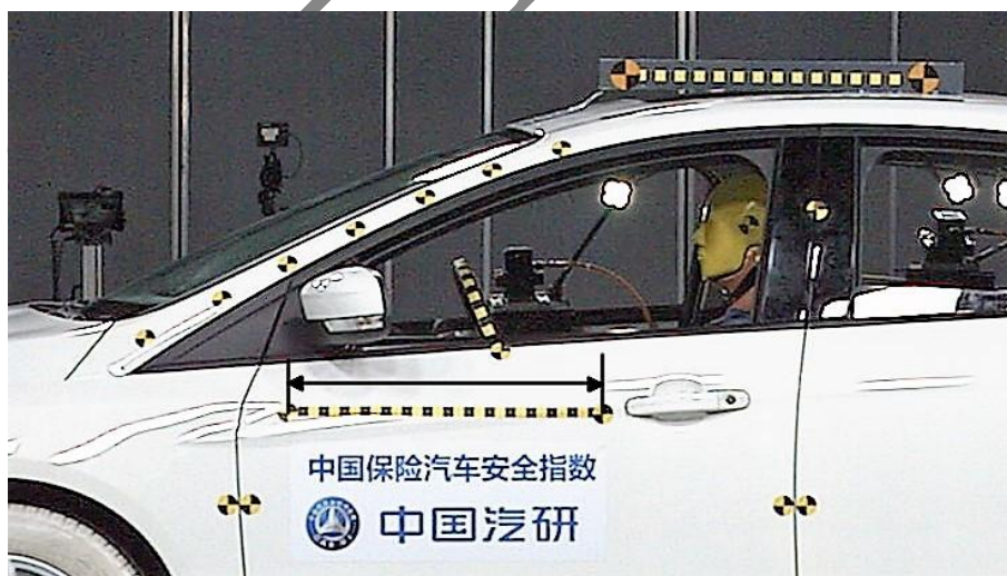
图 B. 2 车门标识之间的水平距离（61cm）
