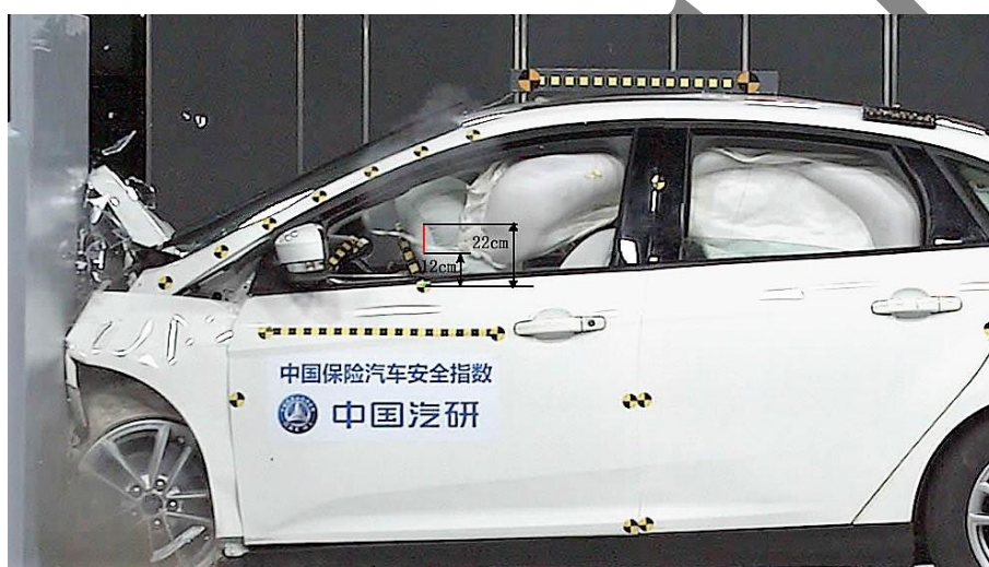
图 B.4 方向盘中心到侧面头部保护气囊前端的距离测量
