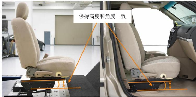
图 5 座椅在车辆和台车上的安装
