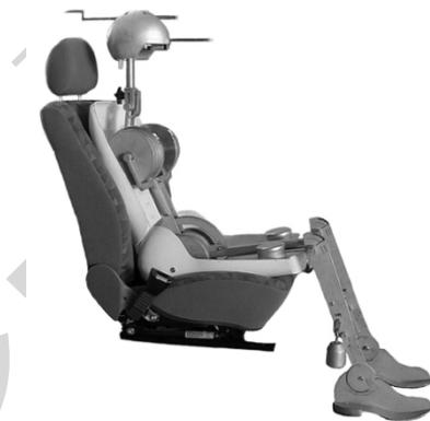
图 1 安装有头枕测量装置的 HPM
