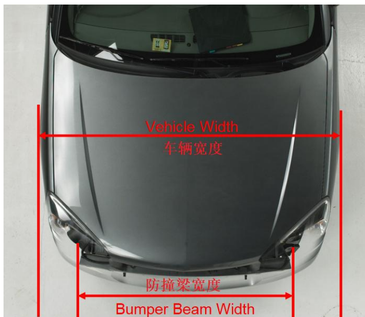
图 5 车辆宽度及防撞梁宽度测量示意图
