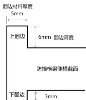
图 A. 1 翻边结构的防撞横梁高度测量
