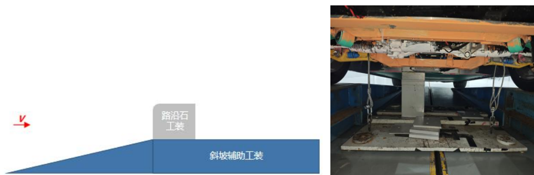
图 A. 2 刮底工装摆放示意图
